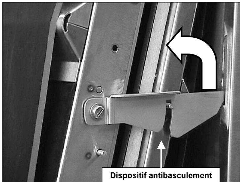
6. Faites glisser la courroie usagée pour l'enlever du rouleau et remplacez-la par la nouvelle courroie. Une fois la nouvelle courroie correctement placée sur son rouleau, remettez le dispositif antibasculement en place.
